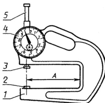
1 - корпус; 2 - пятка; 3 - измерительный наконечник; 4 - отсчетное устройство; 5 - измерительный стержень; A - вылет
